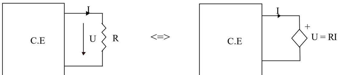
Figura 1. Circuito equivalente con una fuente de tensión.
