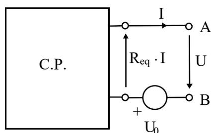
Figura 11. Determinación de la tensión a circuito abierto a partir de una fuente de tensión.
