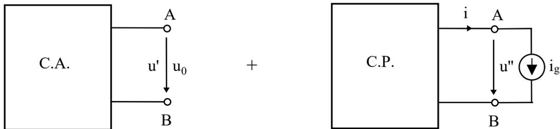
Figura 9. Determinación de las variables de un circuito mediante el teorema de superposición.
