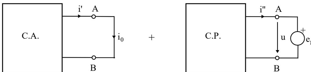
Figura 7. Determinación de las variables eléctricas entre dos puntos en un dipolo.
