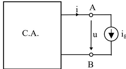
Figura 8. Determinación de un dipolo a partir de una fuente de intensidad.
