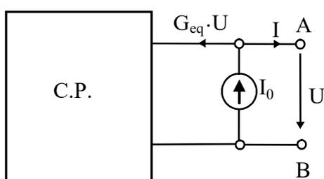
Figura 12. Determinación de la tensión a circuito abierto a partir de una fuente de intensidad.
