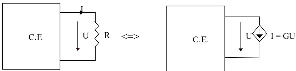
Figura 2. Circuito equivalente con una fuente de intensidad.
