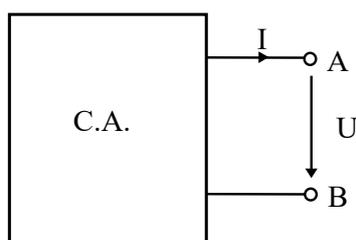
Figura 10. Determinación de la tensión a circuito abierto de un dipolo.
