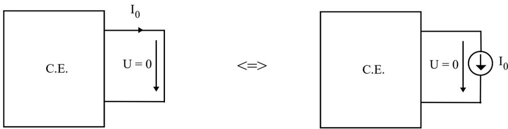
Figura 4. Determinación de la corriente de cortocircuito.
