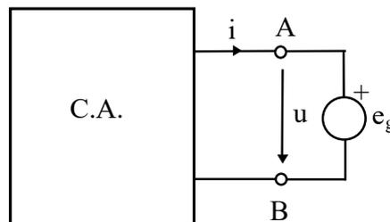
Figura 6. Determinación de la relación tensión e intensidad en un dipolo.
